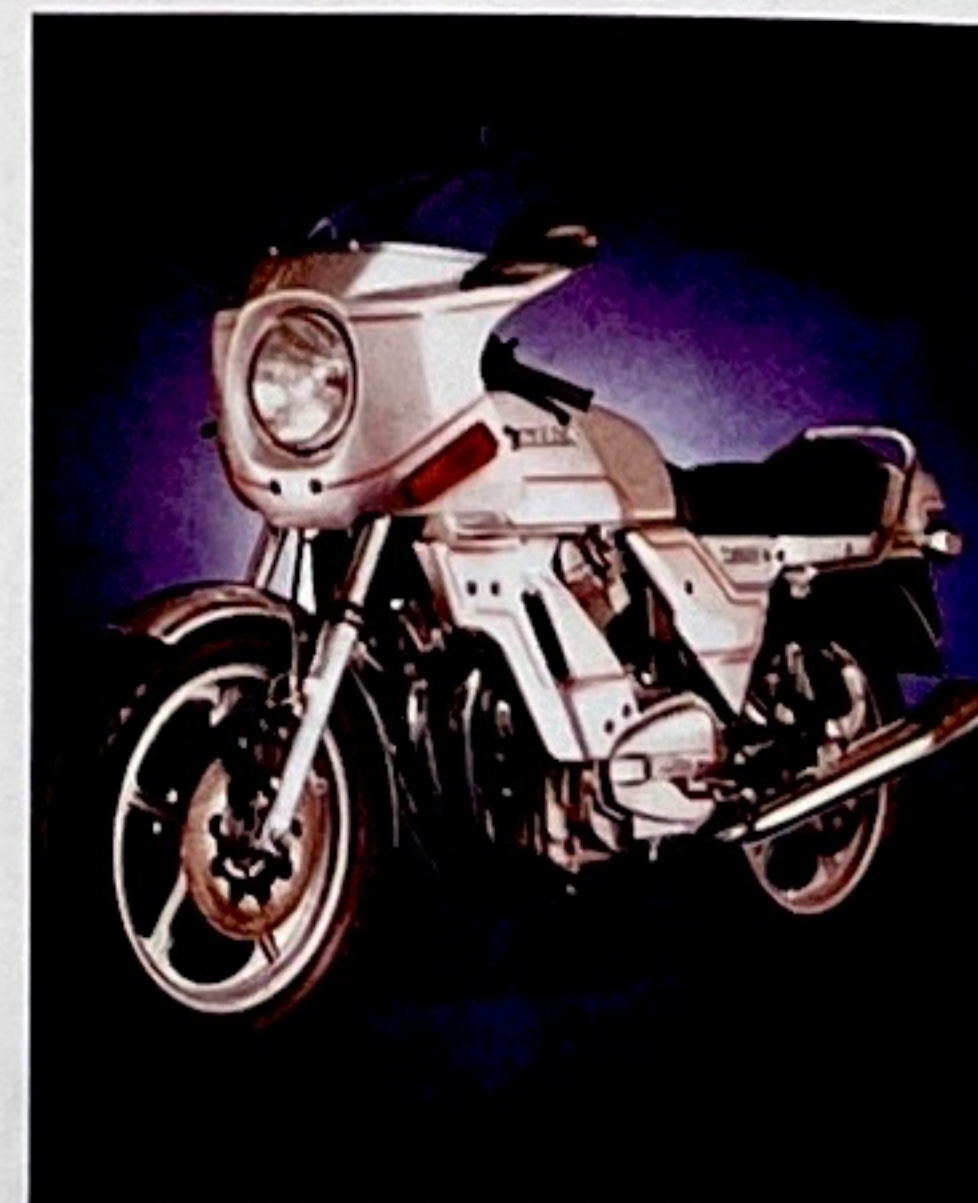
1979 Laverda 1200 TS: um je fünf Millimeter aufgebohrte 1000er, komplett mit Cockpit-verkleidung und Tieferlegung
