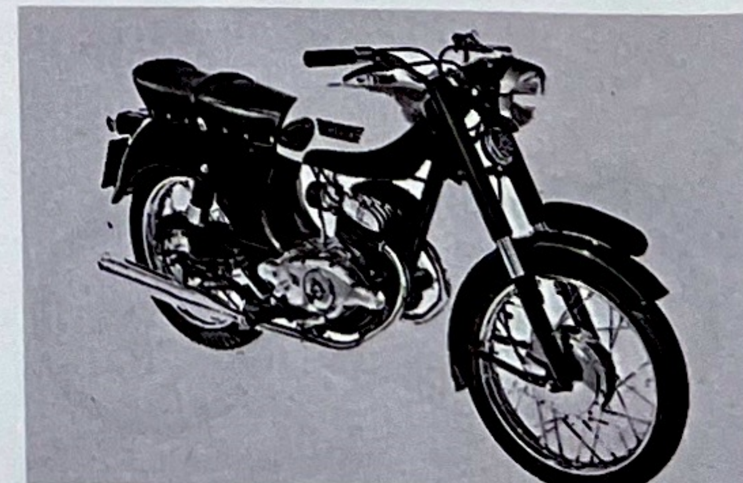
1961 Die Bicilindrico 200 mit Elf-PS-Viertakt-Twin war bis 1976 im Angebot und hatte auch in den USA Erfolg
