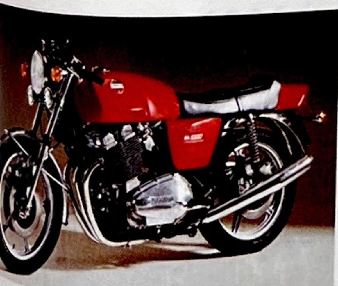
1976 Laverda 1000-Dreizylinder, mit Aluminiumgussrädern und Scheibenbremse auch hinten
